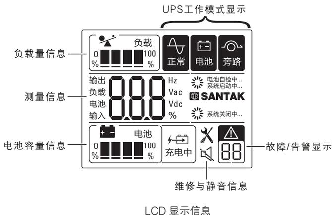
1. 负载信息：负载量显示，用 % 表示，当 UPS 处于过载状态，过载“ ”图标闪烁，1 秒 1 闪。档位显示规格如下：
