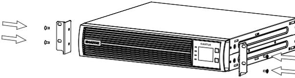
3. 按下图所示方向将 UPS 主机或电池箱放入机架的导轨上，推到固定位置并用螺钉将其紧固（导轨可选购）。
