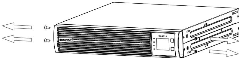
2. 安装挂耳（注意挂耳安装方向，凹形向下）。
